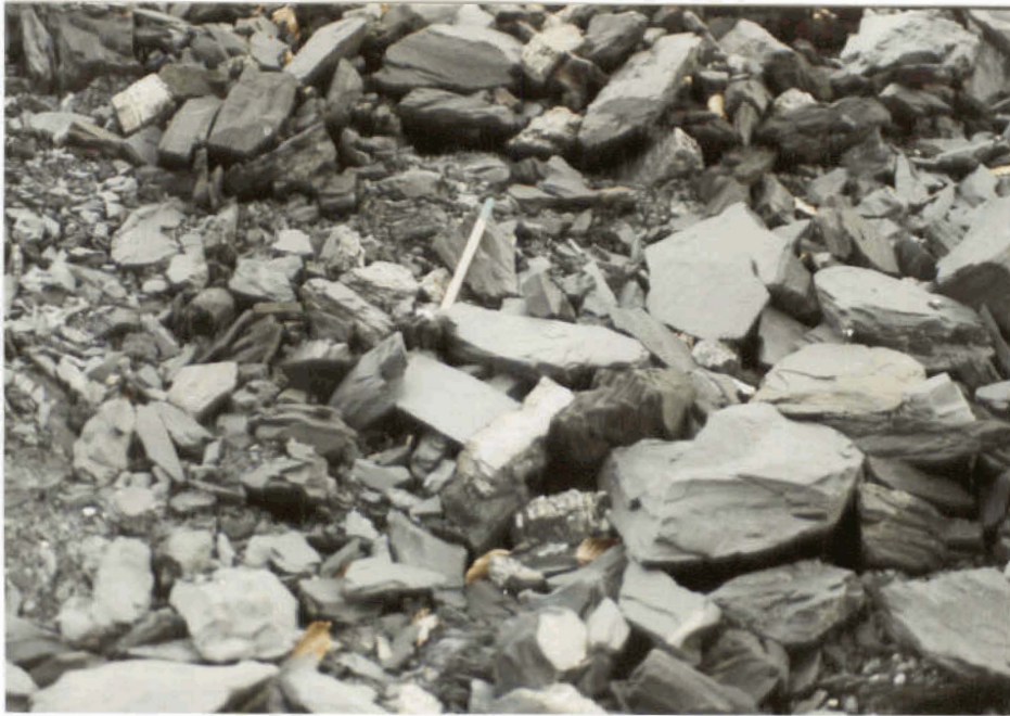
FOTO 6.1.- TAMAÑOS GRANULOMETRICOS EXISTENTES EN EL TODO UNO DE UNA ESCOMBRERA PROCEDENTE DE LABORES DEL INTERIOR.
